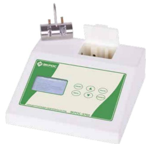
**Принцип действия:** Пробоподготовка включает в себя экстракцию нефтепродуктов из исследуемых образцов органическими растворителями. Далее производится измерение оптической плотности раствора нефтепродуктов, жиров и НПАВ в инфракрасной области спектра.
