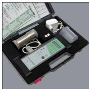
**Назначение:** Определение октанового числа автомобильных бензинов и цетанового числа дизельных топлив в процессе оперативного контроля в полевых и лабораторных условиях.
