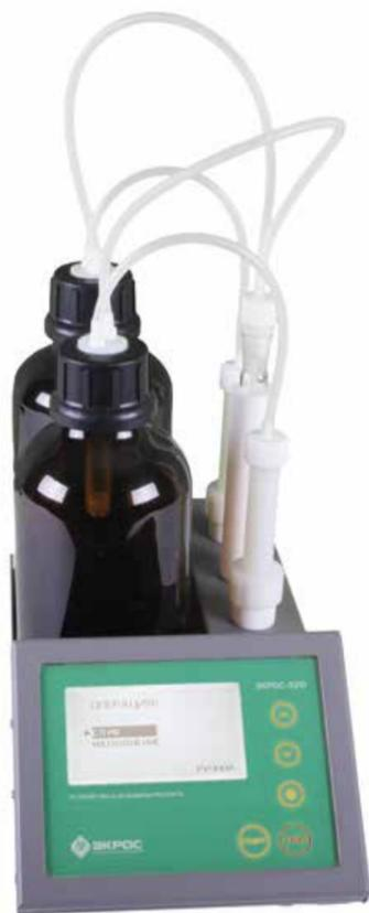
**Назначение:** Для замены отработанного анолита в кулонометрической ячейке титратора Фишера ПЭ-9210 в автоматическом режиме для минимизации непосредственного контакта оператора с токсичным реагентом и повышения производительности выполнения анализов.
